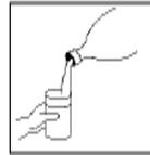
Schrauben Sie den Behälter auf und füllen Sie ihn bis zur Linie mit Wasser (siehe Anfeuchteranweisungen). Schrauben Sie dann den Deckel auf dem Anfeuchterbehälter fest, bis Undichtheiten beseitigt sind.
